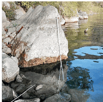
● Il lago Albano con all'interno l'idrometro per misurare il livello dell'acqua
